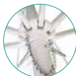
Verrouillage avec goupille et chaîne
